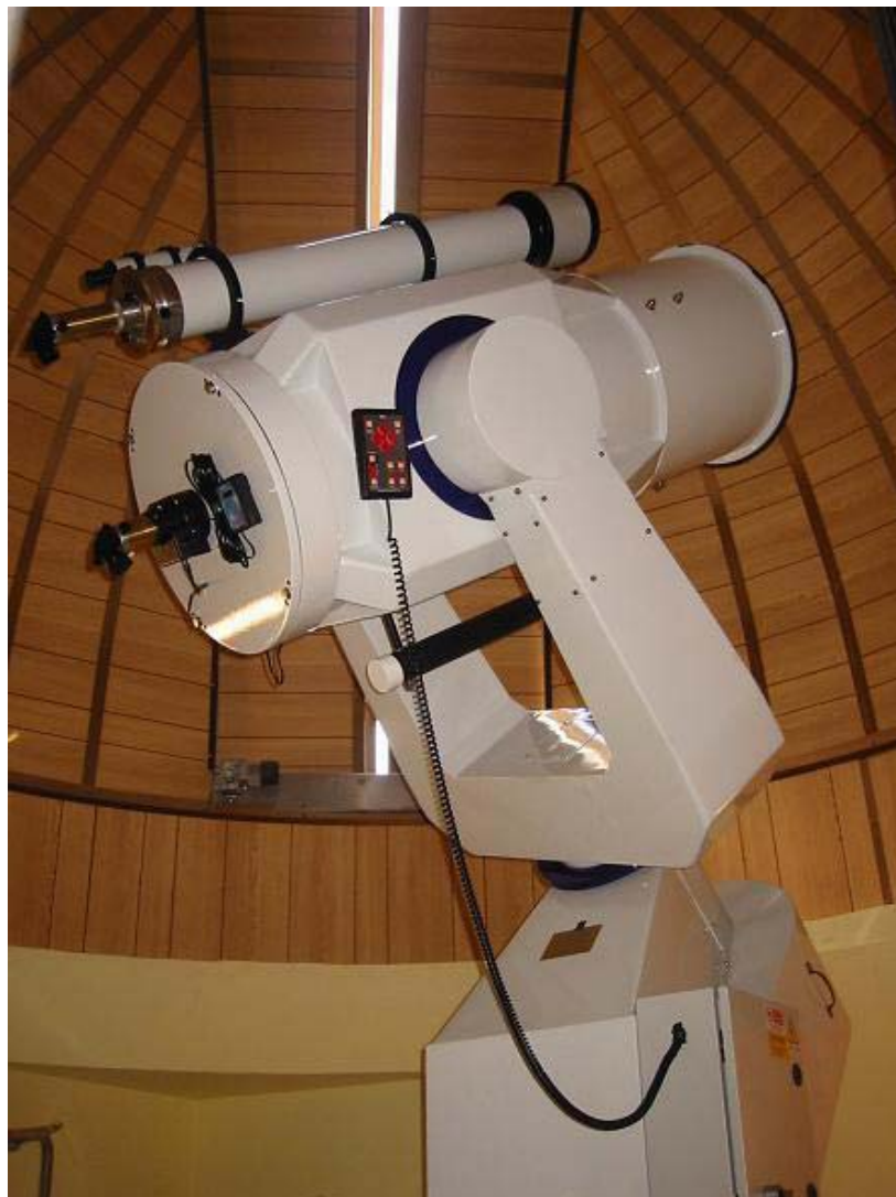
Telescopio Keplero: Ritchey-Chretien da 400mm F/8 della ditta Gambato
